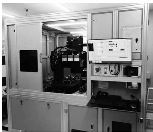
3波長の超短パルスレーザーが出せる加工研究用の超高精密フェムト秒レーザー加工機も生産
