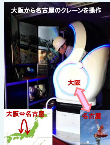
クレーン遠隔操縦
